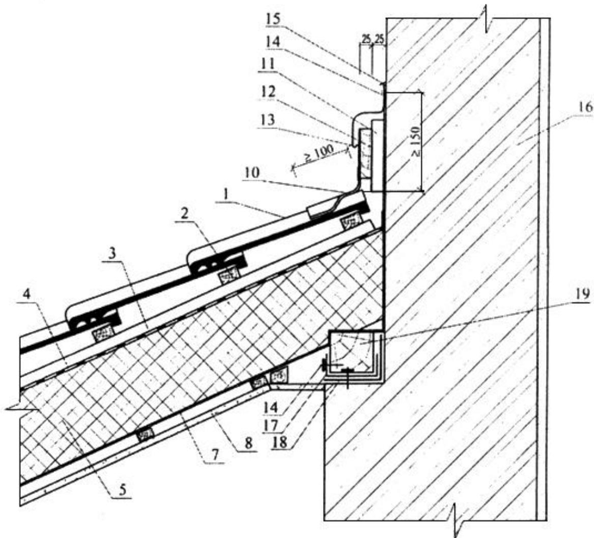
1 - черепица; 2 - обрешетка; 3 - контробрешетка; 4 - ветрогидрозащитная пленка; 5 - утеплитель; 5' - негорючий утеплитель; 6 - труба; 7 - пароизоляция; 8 - внутренняя обшивка; 9 - дренажный желоб; 10 - рулонный самоклеящийся материал; 11 - каркас вентиляционного канала; 12 - доска; 13 - фартук (капельник); 14 - крепежный элемент; 15 - герметик; 16 - стена; 17 - П-образная металлическая скоба; 18 - гидроизоляция; 19 - брус
