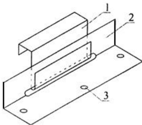
1 - стенка; 2 - основание кляммера; 3 - отверстие для крепления
