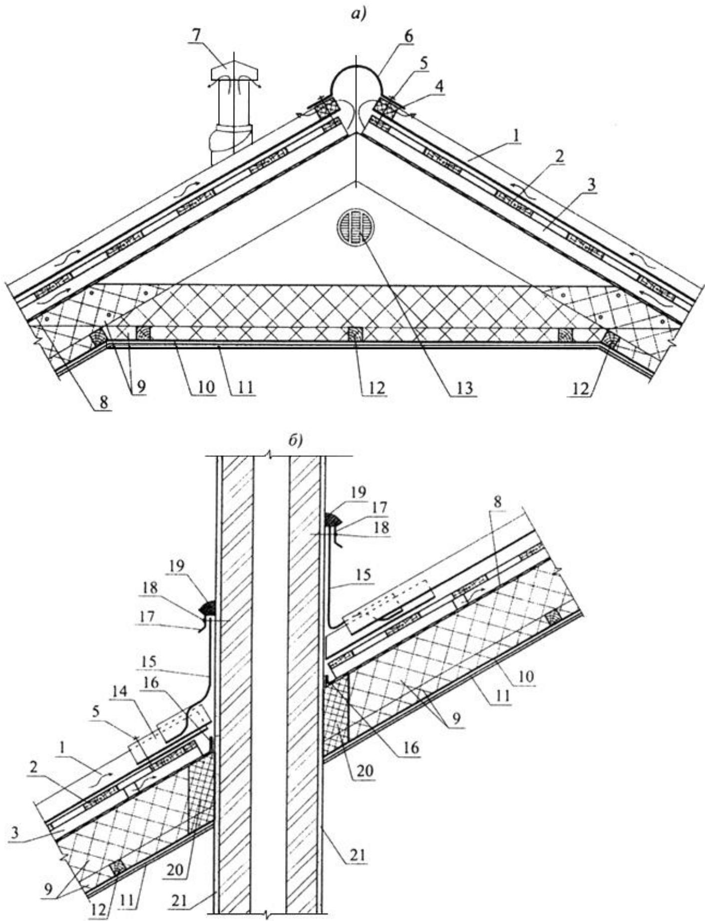
1 - волнистый лист; 2 - обрешетка; 3 - контробрешетка; 4 - уплотнитель без вентиляционных отверстий; 5 - гвоздь с закрывающейся шляпкой; 6 - коньковый элемент; 7 - венттруба; 8 - ветро-гидрозащитная пленка; 9 - теплоизоляция; 10 - пароизоляция; 11 - гипсокартон; 12 - бруск; 13 - щипцовое окно; 14 - фартук; 15 - вертикальная часть фартука; 16 - герметизирующая лента; 17 - металлическая планка; 18 - дюбель; 19 - герметик; 20 - минвата (негорючая); 21 - кирпичная труба
