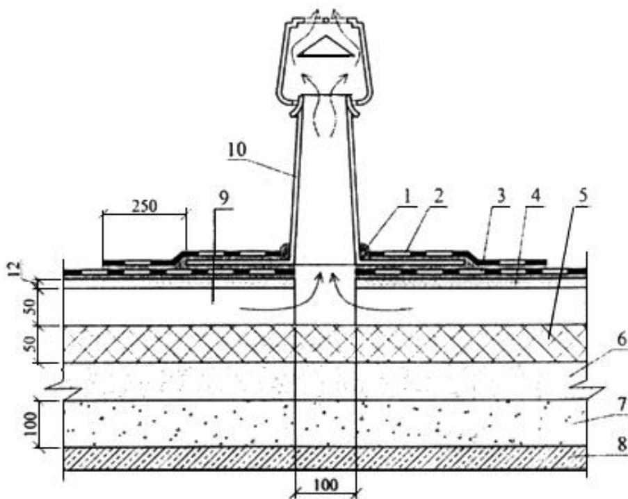
1 - герметик; 2 - дополнительный слой водоизоляционного ковра; 3 - основной слой ковра; 4 - сборная стяжка из ЦСП; 5 - минераловатные плиты; 6 - монолитная (существующая) стяжка; 7 - увлажненный пенобетон; 8 - железобетонная несущая плита; 9 - вентилируемый канал; 10 - аэратор  $\varnothing 100$  мм
