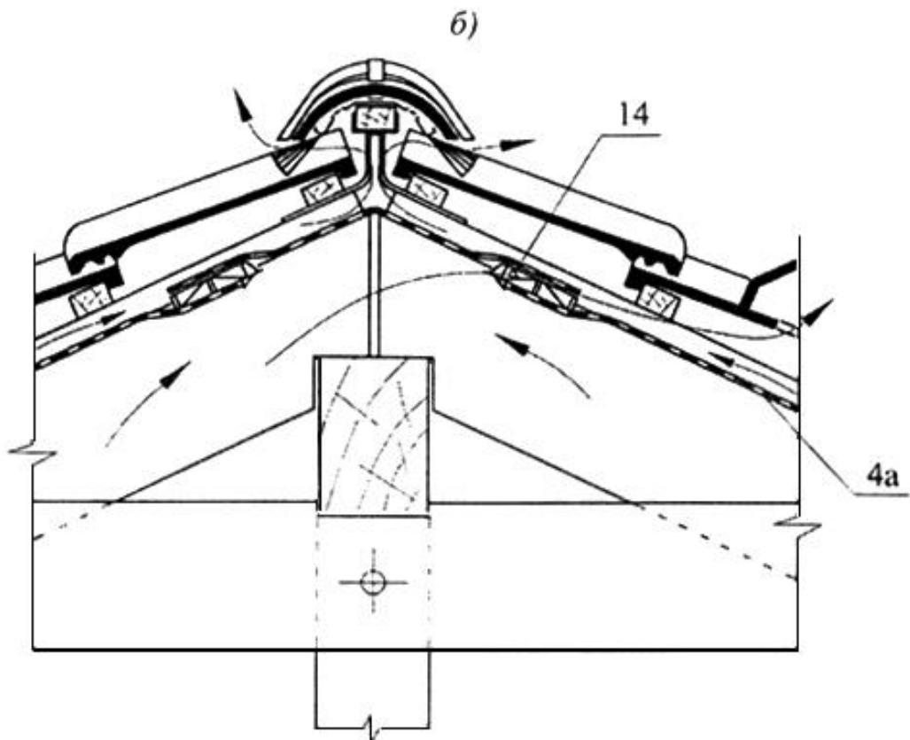
1 - черепица; 2 - обрешетка; 3 - контробрешетка; 4 - ветроgidрозащитная пленка; 4а - гидрозащитная пленка; 5 - утеплитель; 6 - пароизоляция; 7 - коньковая черепица; 8 - аэроэлемент конька; 9 - коньковый бруск; 10 - зажим коньковой черепицы; 11 - крепление конькового бруска; 12 - коньковый прогон; 13 - внутренняя обшивка; 14 - вентиляционный элемент; 15 - болтовое соединение; 16 - столб; 17 - ригель; 18 - приклейка пароизоляции
