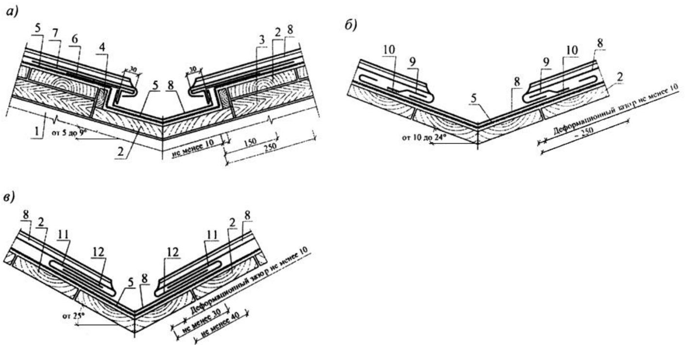
а - на кровлях с уклоном от 5 до 9° (9-16%); б - на кровлях с уклоном от 10 до 24° (18-45%); в - на кровлях с уклоном от 25° (47%); 1 - стропило; 2 - обрешетка; 3 - доборный брус; 4 - доска; 5 - объемная диффузионная мембрана; 6 - костыль; 7 - металлическая полоса; 8 - кровля из металлических листов; 9 - фальшпланка; 10 - припой; 11 - загнутый край нижней картины; 12 - загнутый край верхней картины
