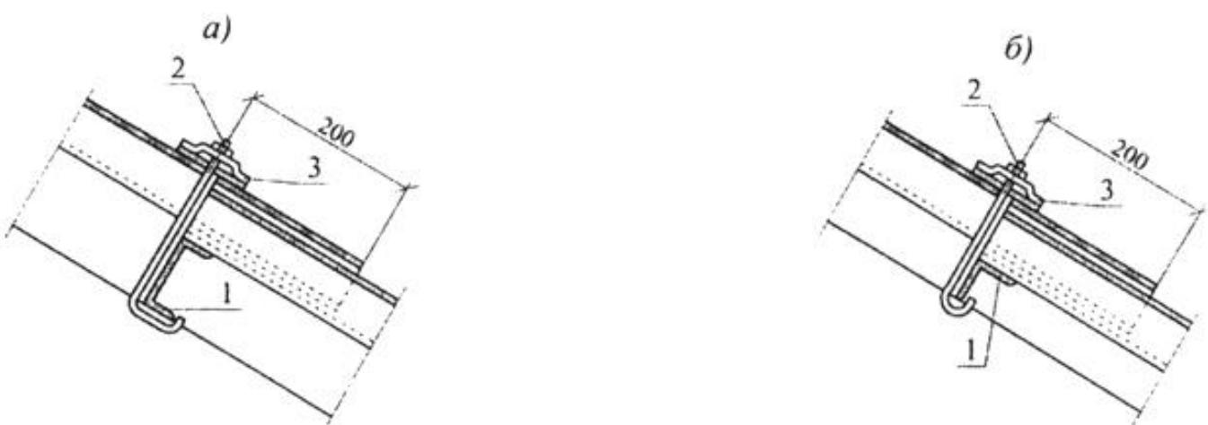
1 - прогон; 2 - крепежный элемент типа "крюк"; 3 - шайба
