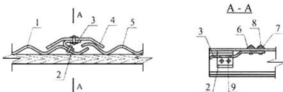
1 - накрываемый край волнистого листа; 2, 3 - скоба; 4 - лотковая деталь; 5 - край волнистого листа; 6, 7 - шайбы; 8 - винт с полукруглой головкой; 9 - заклепка
