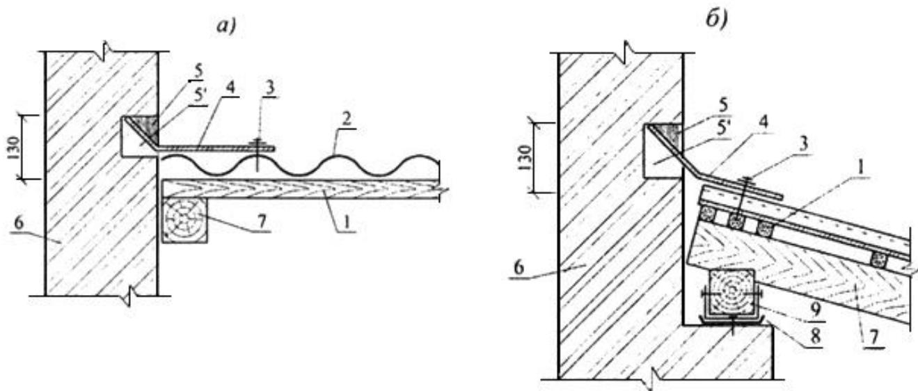
1 - обрешетка; 2 - лист; 3 - гвоздь (шуруп); 4 - уголковая деталь; 5 - герметик; 5' - цементно-песчаный раствор; 6 - стена; 7 - стропило; 8 - гидроизоляция из рулонного материала; 9 - мауэрлат
