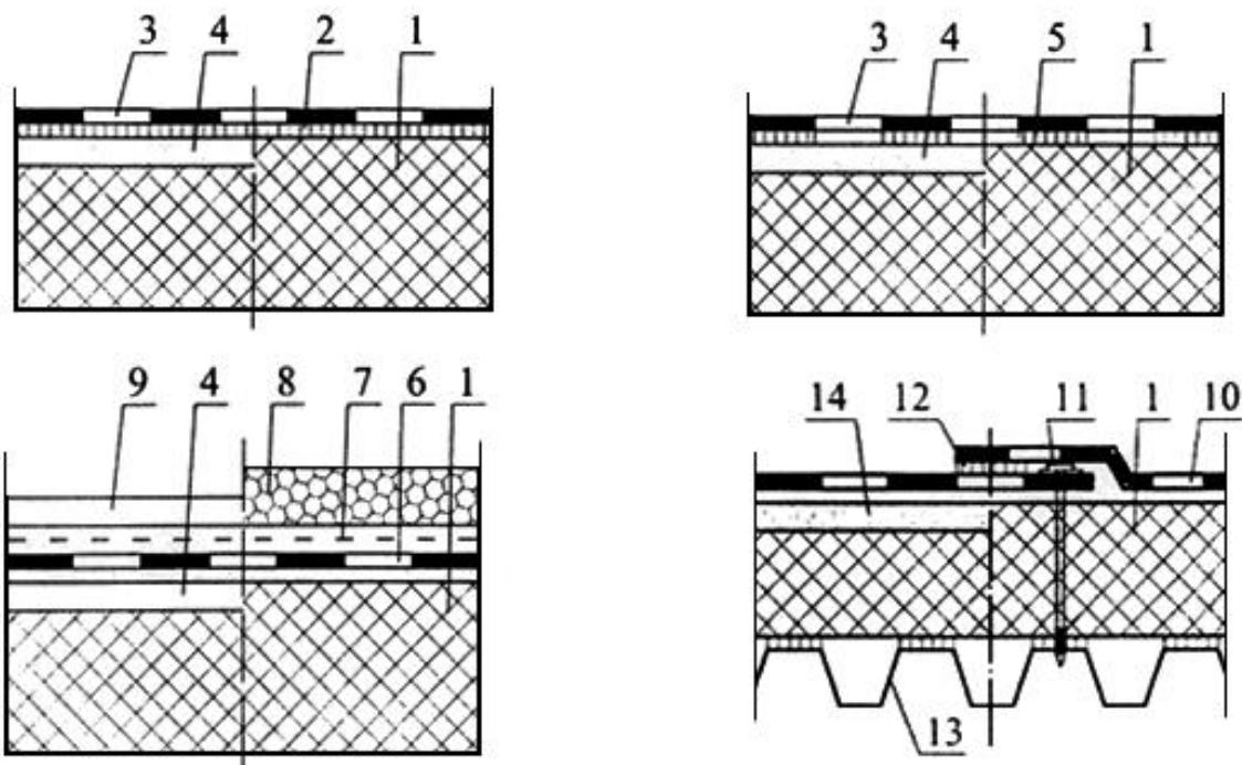
1 - теплоизоляция; 2 - сплошная приклейка; 3 - ковер; 4 - выравнивающая стяжка; 5 - частичная приклейка ковра; 6 - свободно уложенный ковер; 7 - разделительный слой; 8 и 9 - пригруз из гравия или бетонных плиток (монолитный цементно-песчаный раствор, асфальтобетон); 10 - механически закрепленный ковер; 11 - крепежный элемент с шайбой; 12 - приклейка (сварка) продольных кромок рулонных материалов; 13 - профнастил; 14 - сборная стяжка
