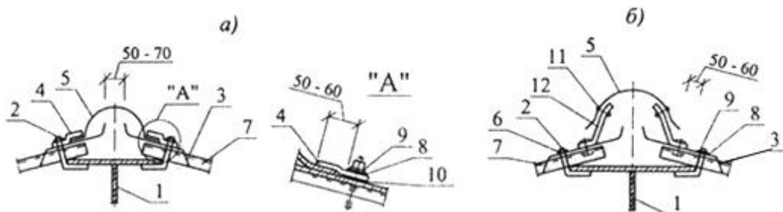
1 - прогон; 2 - крепежный элемент; 3 - гребенка; 4 - прижимная скоба; 5 - коньковая деталь; 6 - гайка; 7 - волнистый лист; 8 - уплотнительная шайба; 9 - стальная шайба; 10 - уплотнительная прокладка; 11 - заклепка; 12 - опорный элемент из стальной полосы
