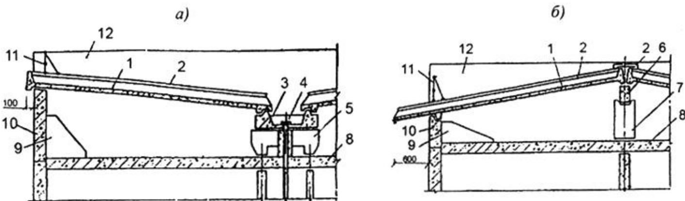
*a* - с внутренним водоотводом; *б* - с неорганизованным водоотводом; 1 - железобетонная кровельная панель; 2 - железобетонный П-образный нащельник; 3 - железобетонный водосборный лоток; 4 - водосточная воронка; 5 - подкладочная балка под лоток; 6 - опорная балка; 7 - опорный столик; 8 - утепленная панель перекрытия; 9 - треугольный анкерный элемент; 10 - опорная фризовая панель; 11 - ограждение крыши; 12 - торцевая фризовая панель
