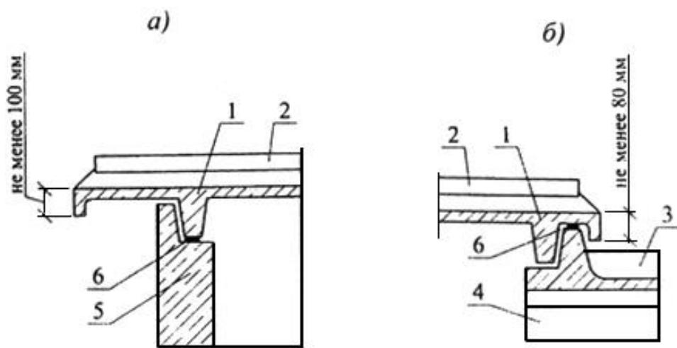
1 - кровельная панель; 2 - П-образный нащельник; 3 - водосборный лоток; 4 - подкладочная балка под водосборный лоток; 5 - парапетная фризовая панель; 6 - герметик
