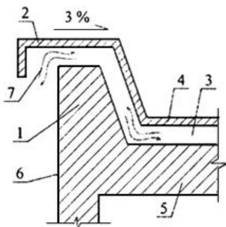
1 - парапет; 2 - козырек; 3 - вентилируемая воздушная прослойка или канал; 4 - верхняя часть покрытия; 5 - нижняя часть покрытия; 6 - стена; 7 - направления движения воздуха
