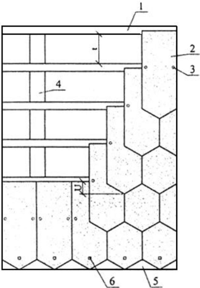
1 - обрешетка; 2 - плитка типа "СОТ"; 3 - крепежный элемент; 4 - стропило; 5 - сплошной настил на карнизе с гидроизоляционным слоем; 6 - противоветровая кнопка;  $t$  - шаг обрешетки;  $U$  - расстояние от нижнего края перекрывающей плитки до верхней кромки плитки предыдущего перед перекрываемым рядом
