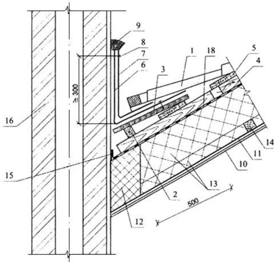
1 - металлическая черепица; 2 - бруск; 3 - деревянный настил; 4 - контробрешетка; 5 - обрешетка; 6 - битумный самоклеящийся рулонный материал; 7 - металлическая деталь; 8 - дюбель; 9 - герметик; 10 - гипсокартон; 11 - пароизоляция; 12 - минвата (негорючая); 13 - теплоизоляция; 14 - бруск; 15 - крепление ветроизолирующей пленки двухсторонней липкой лентой; 16 - труба; 18 - ветроизолационная пленка; 18а - ветрозащитный слой (из стеклохолста); 19 - гидроизолирующая пленка
