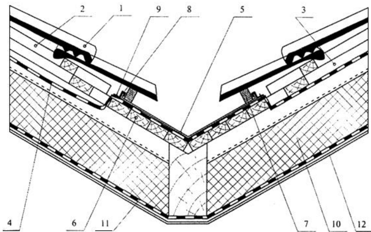
1 - черепица; 2 - обрешетка; 3 - контробрешетка; 4 - гидрозащитная пленка; 5 - алюминиевый окрашенный желобок; 6 - сплошной дощатый настил ендовы; 7 - поролоновая полоса; 8 - скоба крепления желоба; 9 - оцинкованный гвоздь; 10 - утеплитель с покровным (ветрозащитным) слоем; 11 - пароизоляция; 12 - внутренняя обшивка
