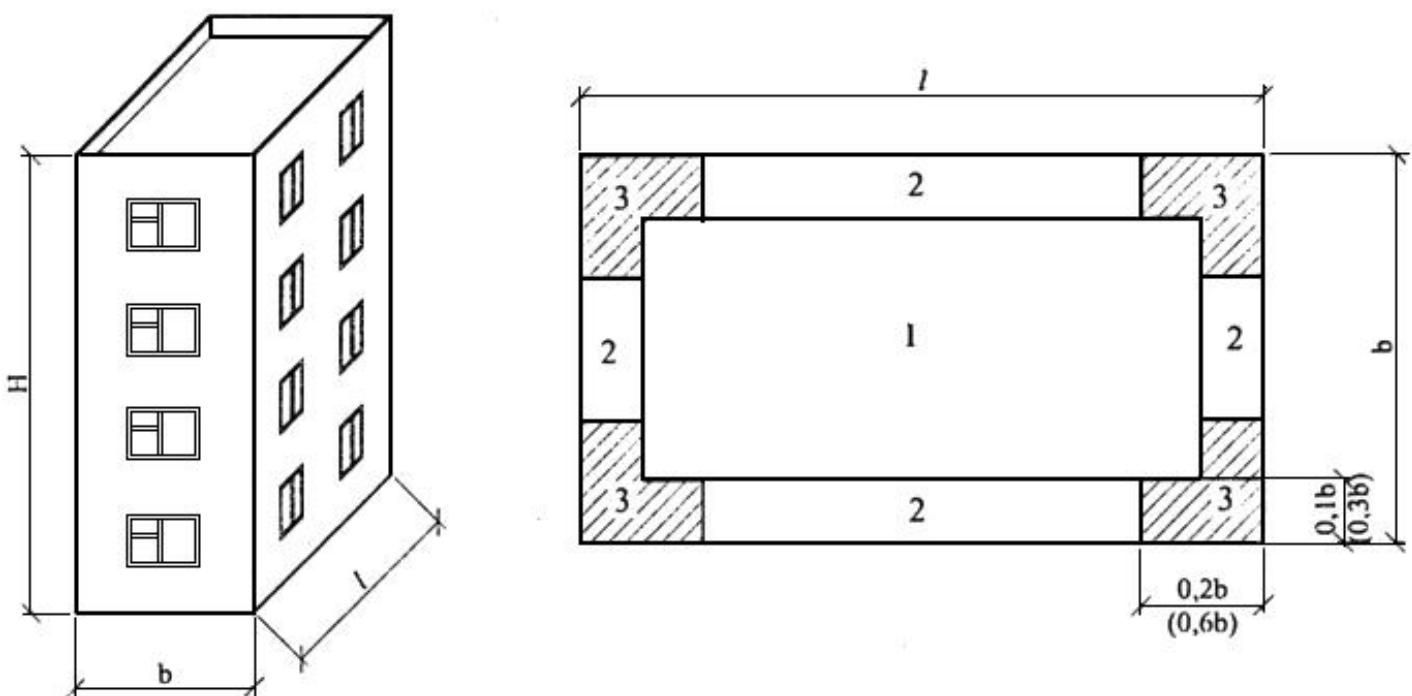
1 - центральная зона ( $c = 1,0$ ); 2 - краевая зона ( $c = 2,0$ ) и 3 - угловая зона ( $c = 2,5$ ) Для кровли с уклоном более  $6^\circ$  (11%) для угловой зоны  $c = 3,0$
