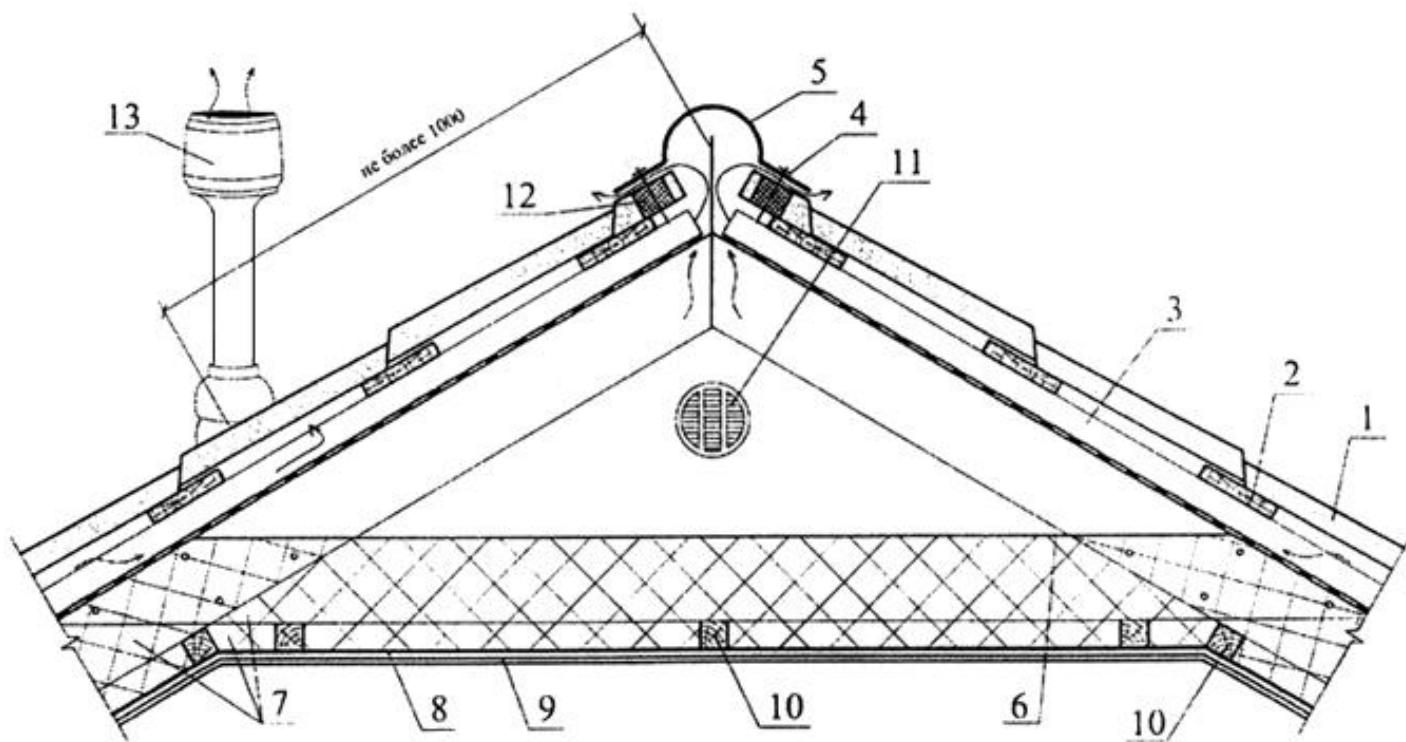
1 - металлическая черепица; 2 - обрешетка; 3 - контробрешетка; 4 - гвоздь с закрывающейся шляпкой; 5 - коньковый элемент; 6 - ветрогидрозащитная пленка; 7 - теплоизоляция; 8 - пароизоляция; 9 - гипсокартон; 10 - бруск; 11 - щипцовое окно; 12 - уплотнитель; 13 - вытяжка
